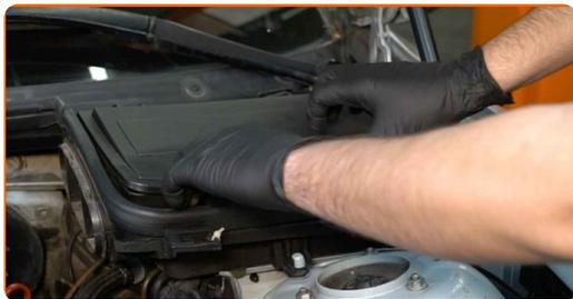
**5** Irroita sisäilmasuodattimen kotelon suojus.
