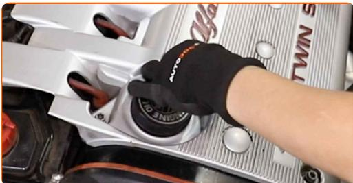
**27** Ruuvaa moottorin suojakannen kiinnikkeet kiinni. Käytä Torx-avainta T40. Käytä kiintolenkkiavainta.
