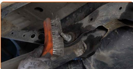
7 Tee merkki camber-kulman säätöpulttiin.
