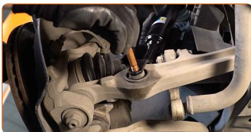
**47** Kiinnitä ylempi kolmiotukivarsi olka-akseliin. Käytä kuminuijaa. Käytä metallille tarkoitettua tasatalttaa. Käytä vasaraa.
