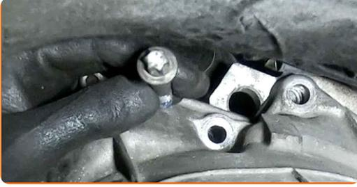
68 Kierrä kiinni kiinnikkeet, jotka yhdistävät vaihdelaatikon moottorilohkoon. Käytä Torx-avainta E14. Käytä kiintolenkkiavainta.
