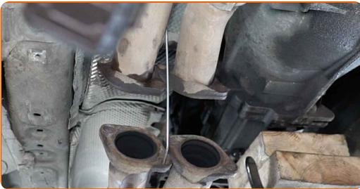
30 Kierrä irti pakoputkiston lämpösuojaan kiinnikkeet. Käytä hylsyä nro 10. Käytä kiintolenkkiavainta.
