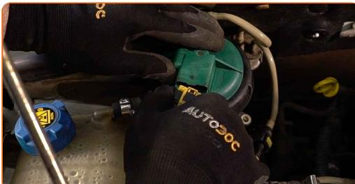
**4** Irrota polttoainesuodattimen suojuksen.
