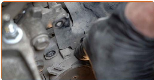
**110** Kierrä kiinni moottorin johtosarjan kannattimen kiinnikkeet. Kierrä kiinni laturin johtosarjan kannattimen kiinnikkeet. Käytä hylsyä nro 10. Käytä kiintolenkkiavainta.
