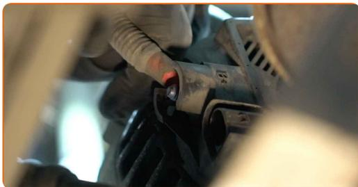
**19** Irrota laturin johtosarjan kiinnike kannattimesta. Käytä kiinnikkeiden irrotustyökalua.
