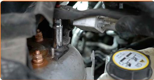
52 Vapauta jäähdytysnestesäiliön pidikkeet. Käytä kiinnikkeiden irrotustyökalua.
