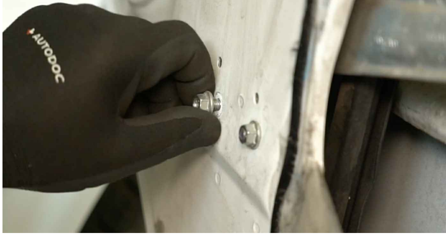
19 Irrota ikkunannostimen mekanismi.
