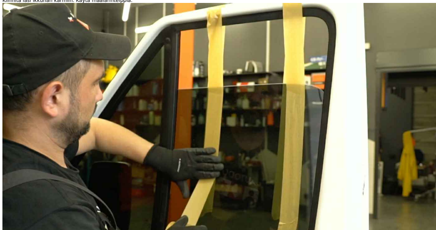
Varoitus! • Pidä lasista kiinni, kun nostat ja kiinnität sitä, jotta se ei vaurioidu ja jotta vältät loukkaantumiset.
