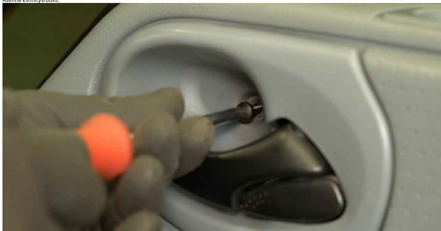
42 Kiristä ovipahvin kiinnikkeet. Käytä ristipääruuvimeisseliä.
