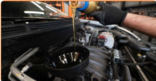
Vaihto: moottoriöljyn ja suodattimen – INFINITI FX. Vinkki:
