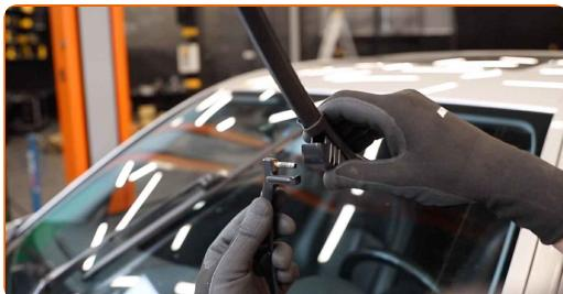
Vaihto: pyyhkijänsulat – MERCEDES-BENZ Sprinter 3.5-T Flatbed Kuorma-auto/Alusta (W906). Vinkki:
