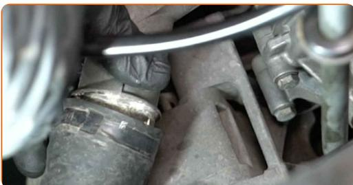
Vaihto: lämpötila-anturi ja termostaatti – MERCEDES-BENZ SPRINTER 3-t Bussi (903). AUTODOC suosittelee:
