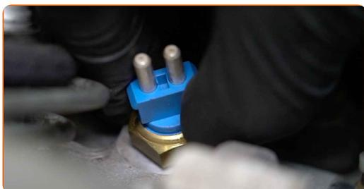
Vaihto: lämpötila-anturi ja termostaatti – MERCEDES-BENZ SPRINTER 3-t Bussi (903). AUTODOCin asiantuntijoiden vinkki:
