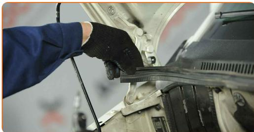
36 Kierrä irti suojakannen kiinnityspultit. Käytä Torx-avainta T30. Käytä kiintolenkkiavainta.
