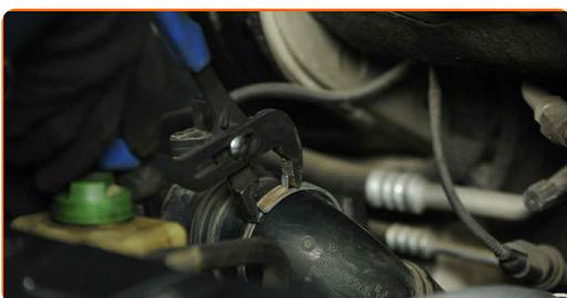
32 Irrota ilmansuodattimen kumikurkku ilmansuodattimen kotelosta.
