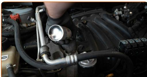
**4** Asenna öljynsuodattimen suojuksen paikoilleen.
