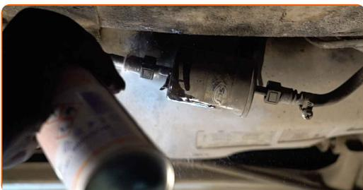
7 Purista klipsejä ja irrota polttoaineen syöttöputket öljynsuodattimen kotelosta. Käytä polttoainelinjapihtejä.
