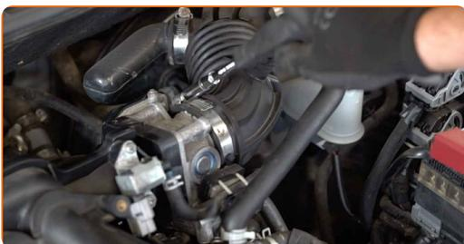
5 Irrota ilmansuodattimen kumikurkku ilmansuodattimen kotelosta.
