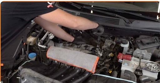
20 Laita sytytyspuolan liitos kiinni.
