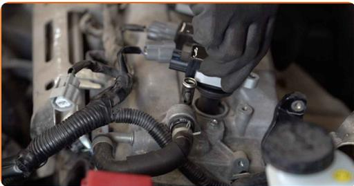
18 Käsittele sytytyspuolan liitin elektroniikan puhdistussprayillä. Spray suojaa sähköisiä kontaktipintoja korroosiolta ja hapettumiselta ja vähentää kosketusvastusta.
