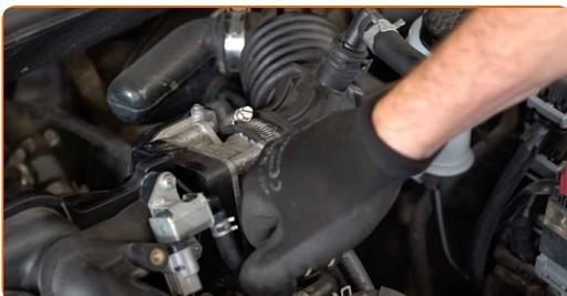
4 Irrota ilmansuodattimen imuletkussa olevat pidikkeet ja kiinnikkeet. Käytä hylsyä nro 10. Käytä kiintolenkkiavainta.
