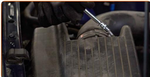
**4** Irrota ilmansuodattimen kumikurkku ilmansuodattimen kotelosta.
