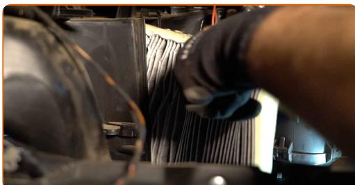
Vaihto: raitisilmasuodatin – OPEL Astra G Coupe (T98). Ammattilaiset suosittelevat:
