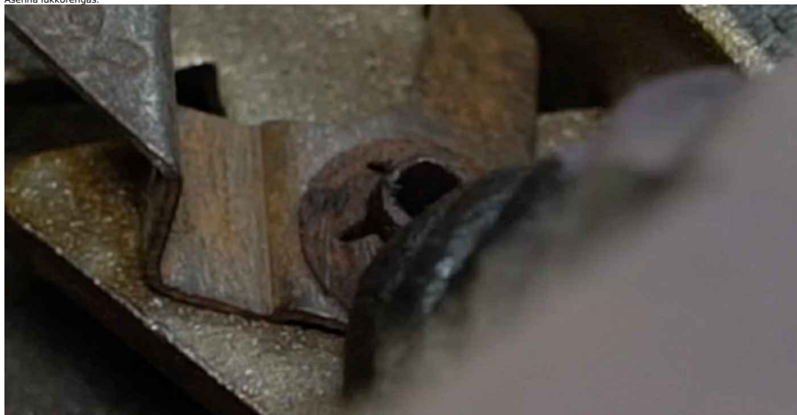
35 Asenna yläosan pidikepiti ja säätömekanismi uusiin jarrukenkiin. Käytä tasapäistä ruuvimeisseliä.
