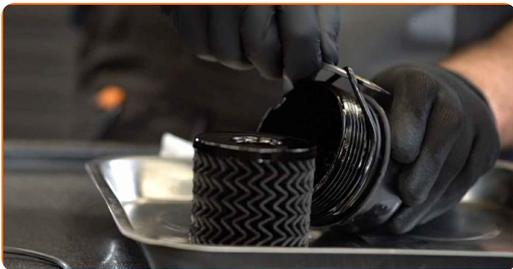
24 Laita O-rengas asennuspaikkaansa suodattimen kotelossa.
