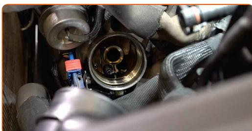
27 Asenna uusi suodatin paikoilleen.
