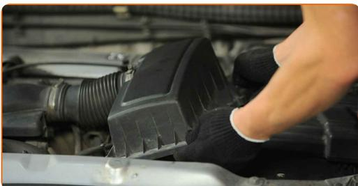
5 Irroita suodatin suodattimen kotelosta.
