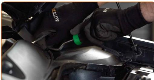
**4** Nosta joustintuen kiinnikkeen suojaa hieman. Käsitlee joustintuen kiinnityksen kiinnikkeet. Levitä WD-40-monitoimiaainetta.
