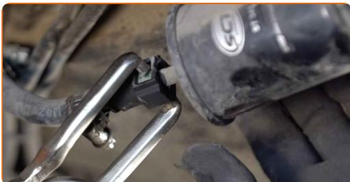
Vaihto: polttoainesuodatin – RENAULT Megane III Van / Hatchback (BZ\_).
