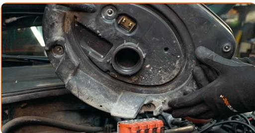
5 Suojaa kaasuläpän runko mikrokuituliinalla, jotta järjestelmään ei pääse pölyä ja likaa.
