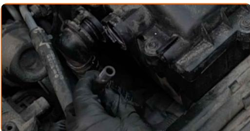
**5** Avaa ilmansuodattimen suojan kiristysruuvit. Käytä Torx-avainta T25. Käytä kiintolenkkiavainta.
