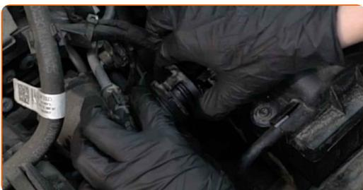
4 Irrota alipaineletku ilmansuodatinkotelosta.
