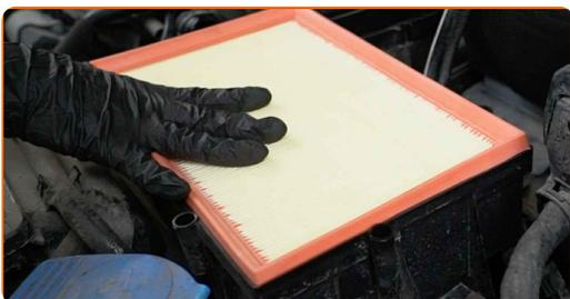
Vaihto: ilmansuodattimen – SKODA Octavia III Hatchback (5E3, NL3, NR3).
