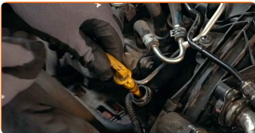
6 Puhdista öljynsuodattimen kotelon korkki. Käytä yleispuhdistussprayta.
