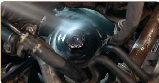
7 Irroita suodattimen kotelonkansi yhdessä vanhan suodattimen kanssa. Käytä hylsyä nro 30. Käytä kiintolenkkiavainta.
