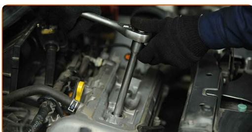
Vaihto: sytytystulpat – SUZUKI Wagon R+ Hatchback (MM). Ammattilaiset suosittelevat:
