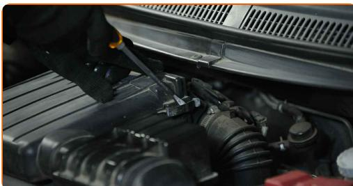
4 Avaa ilmansuodattimen kotelon kiinnikkeet. Käytä hylysyä nro 10. Käytä kiintolenkkiavainta.
