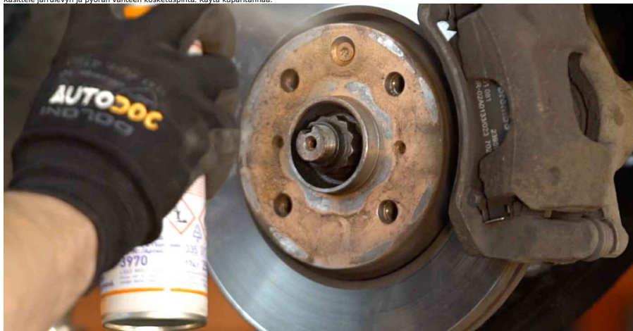
23 Puhdista vanteen kiinnityskohta. Käytä jarrunpuhdistusainetta.
