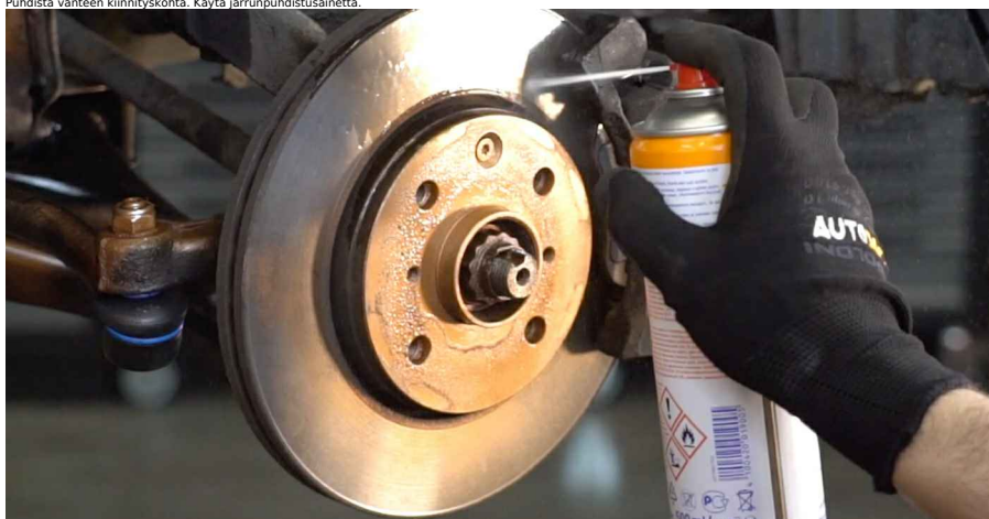
23 Puhdista vanteen kiinnityskohta. Käytä jarrunpuhdistusainetta.
