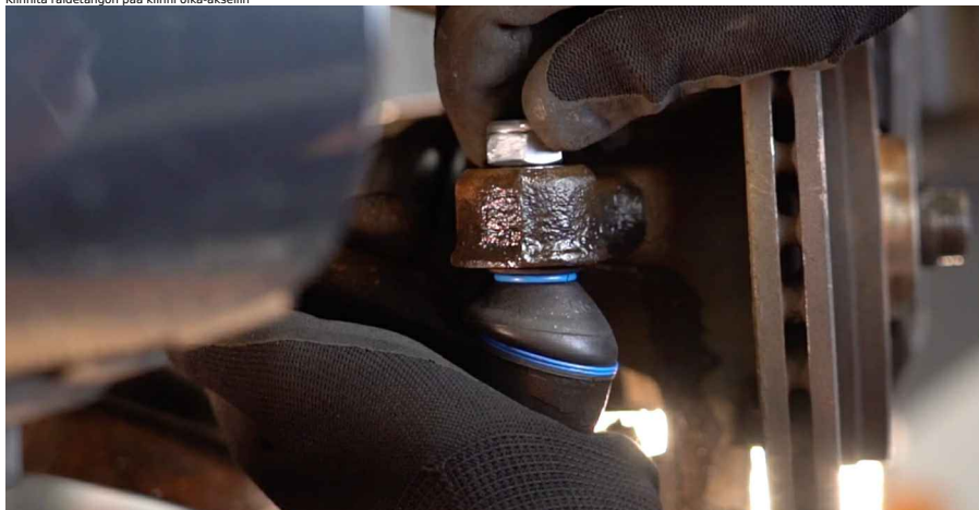
18 Kiristä kiinnitysmutteri, joka yhdistää raidetangon pään olka-akseliin. Käytä hylsyä nro 17. Käytä momenttiavainta. Kiristä sitä 33 Nm vääntömomentilla.
