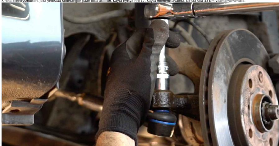
19 Kiristä raidetangon päähän lukkomutteri. Käytä yhdistelmäavainta nro 17. Käytä yhdistelmäavainta nro 19. Käytä momenttiavainta. Kiristä sitä 47 Nm vääntömomentilla.
