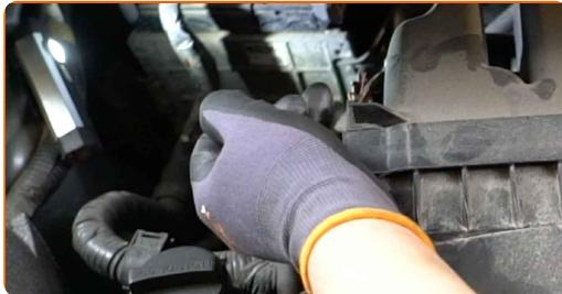
4 Irrota ilmansuodattimen kumikurkku ilmansuodattimen kotelosta.
