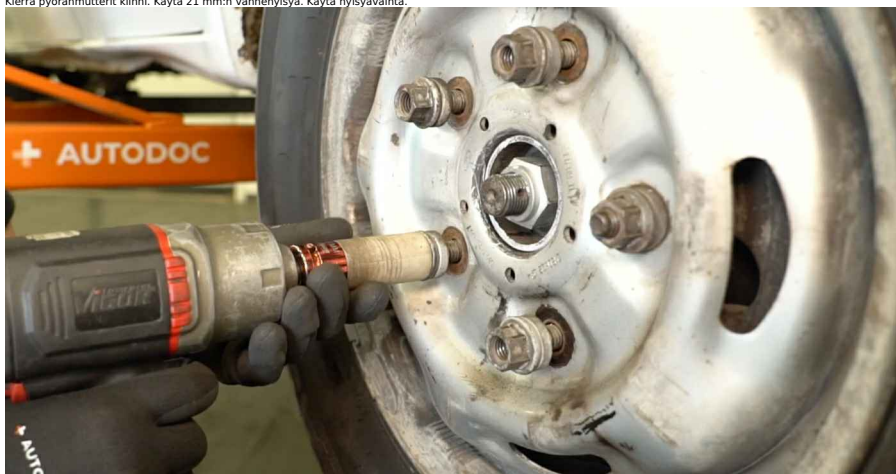
56 Laske auto ja kiristä pyöränmutterit ristikkäin. Käytä 21 mm:n vannehylysyä. Käytä momenttiavainta. Kiristysmomentti: 200 N·m.
