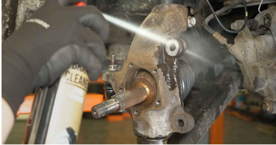
26 Puhdista vetonivelen urat. Käytä teräsharjaa. Käytä yleispuhdistussuihketta.
