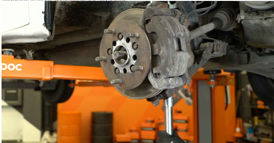
14 Irrota vetoakseli olka-akselista. Käytä pistepuikkoa. Käytä vasaraa.
