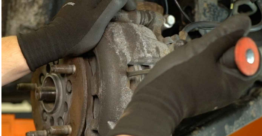
17 Puhdista jarrusatulan pitimen kiinnikkeet. Käytä teräsharjaa. Käytä WD-40-sprayta.
