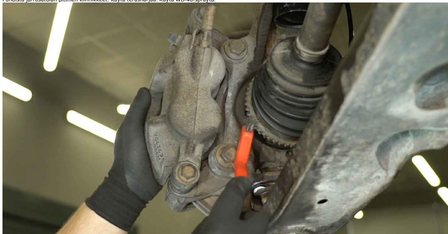
18 Kierrä irti jarrusatulan pitimen kiinnikkeet. Käytä 18 mm:n hylsyä. Käytä T-väännintä.
