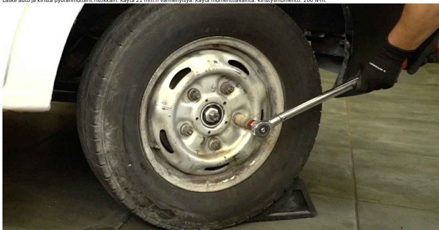
57 Kiristä akselmutteri. Käytä 36 mm:n hylsyä. Käytä momenttiavainta. Kiristysmomentti: 320 N·m.
