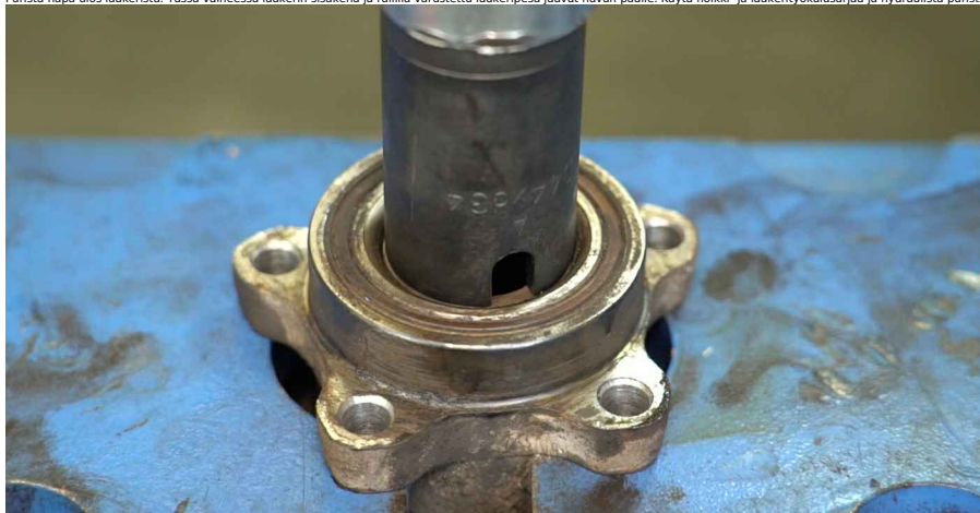
33 Puhdista rasva navan päälle jäävästä laakerin sisäosasta liinalla.
