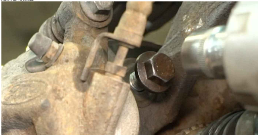
47 Kiristä jarrusatulan pitimen kiinnikkeet. Käytä 18 mm:n hylsyä. Käytä momenttiavainta. Kiristysmomentti: 175 N·m.
