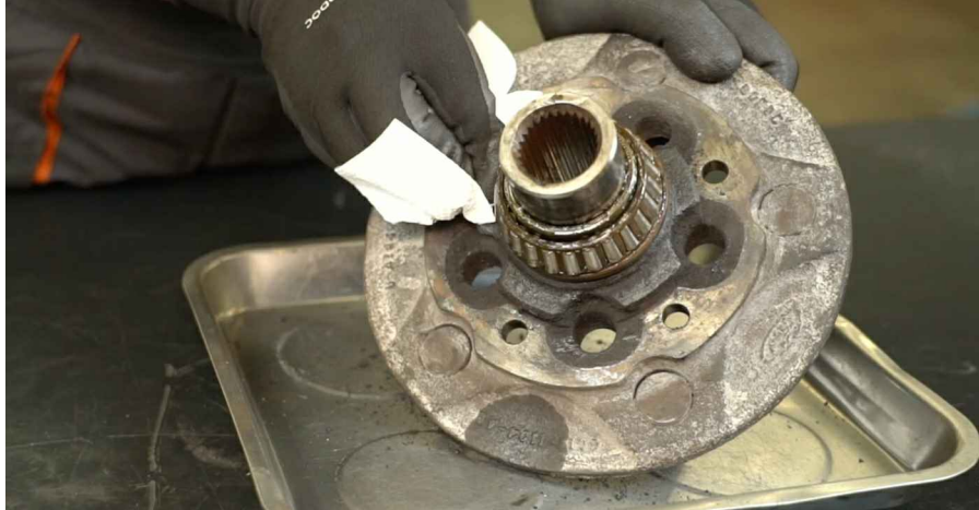
34 Purista napa irti laakerin sisäkehästä. Käytä holkki- ja laakerityökalusarjaa. Käytä laakerin ulosvetäjää ja hydraulista puristinta.
