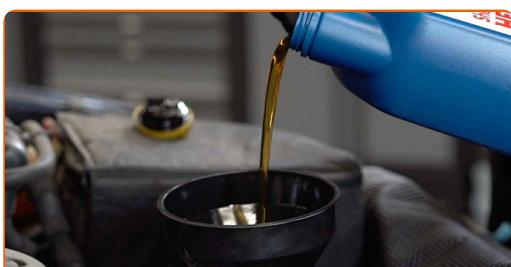
Vaihto: moottoriöljy ja öljynsuodatin – VAUXHALL Agila Mk I (A) (H00).
