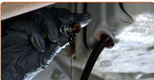
Vaihto: moottoriöljy ja öljynsuodatin – VAUXHALL Ampera (R12).
