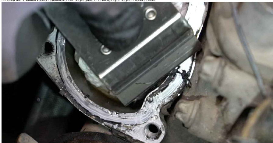
25 Asenna uusi termostaatin kotelo yhdessä termostaatin kanssa.
