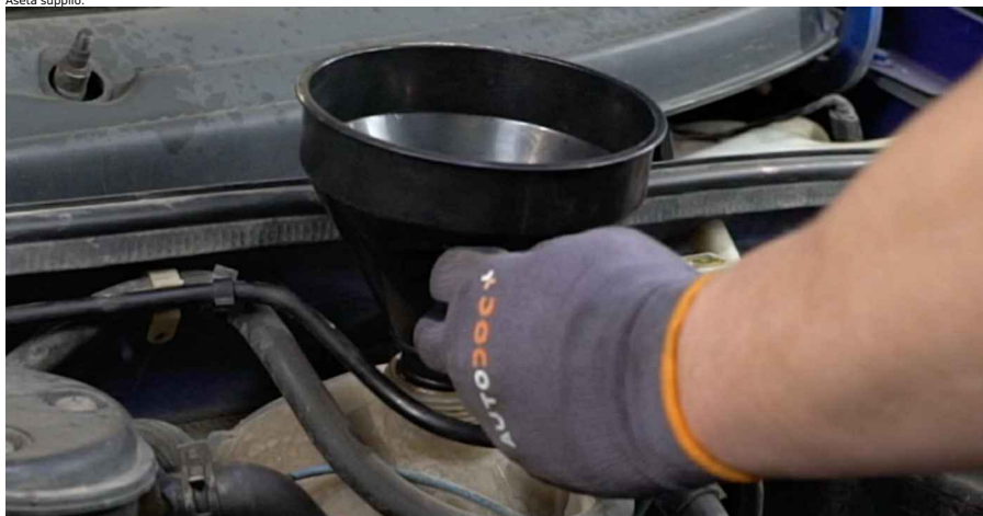
35 Kaada jäähdytysneste jäähdytysnestesäiliöön.
