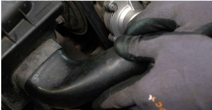
32 Kiinnitä ilmansuodattimen imuletkun kiinnitysnasta.
