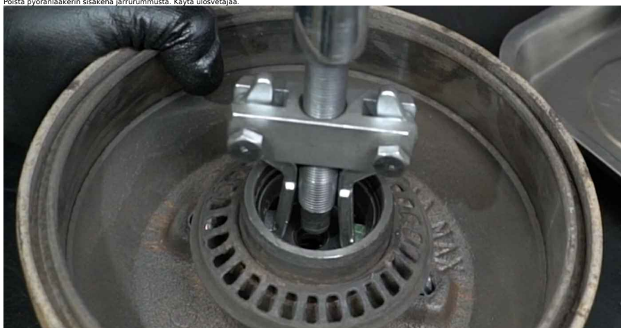
16 Poista pyöränlaakerin ulkokehä jarrurummusta. Käytä laakerien asennustyökälsarjaa.
