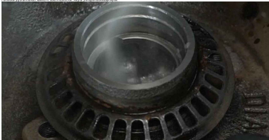
18 Asenna uusi pyöränlaakerin ulkokehä jarrurumpuun. Laakerien asennustyökalusarja.
