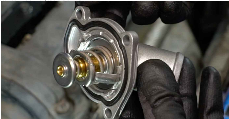
26 Asenna kumiliuska. 27 Kiristä termostaatin kotelon kiinnikkeet. Käytä Torx-avainta T10. Käytä momenttiavainta. Kiristä sitä 6 Nm vääntömomentilla.
