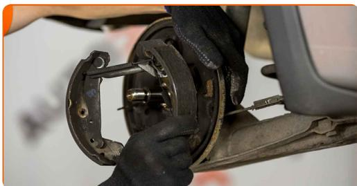
Vaihto: jarrukengät – VAUXHALL Corsa Mk I (B) Hatchback (S93). AUTODOCin asiantuntijat suosittelevat:
