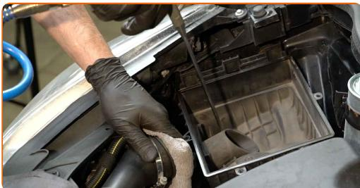
Vaihto: ilmansuodattimen – VAUXHALL Corsa Mk III (D) Hatchback (S07).
