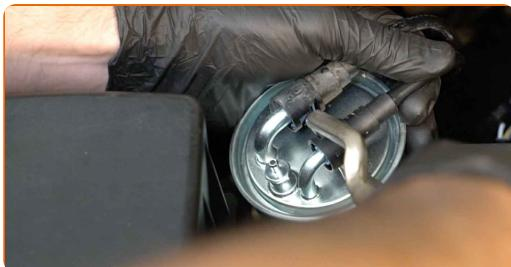
Vaihto: polttoainesuodatin – VAUXHALL Corsa Mk III (D) Hatchback (S07).
