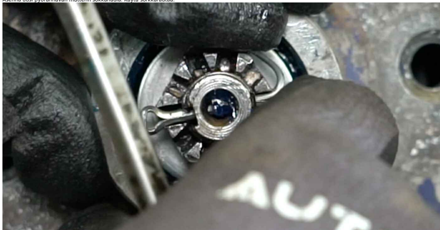
34 Asenna navan mutterin suojuus. Käytä kuminuijaa.
