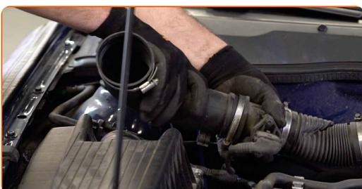
5 Suojaa imuletku mikrokuituliinalla, jotta järjestelmään ei pääse pölyä ja likaa.
