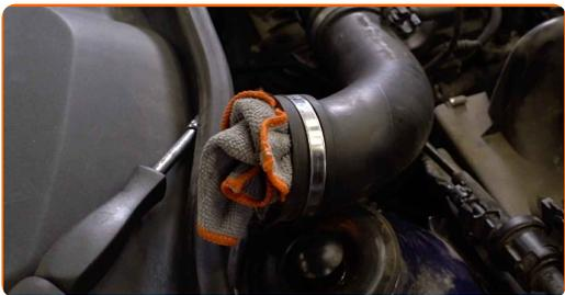
6 Irroita ilmaletkun ja johdinsarjan ilmansuodattimen koteloon yhdistävät kiinnikkeet.
