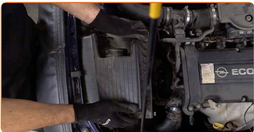
8 Irroita suodattimen kotelon kiinnityspultit. Käytä Torx-avainta T30. Käytä kiintolenkkiavainta.
