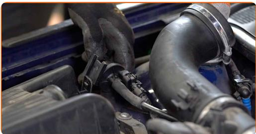
7 Irroita suodattimen kansi. Irroita suodatintuuletin suodattimen kotelosta.
