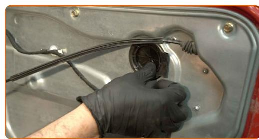
Asenna kannet ikkunannostimen kiinnikkeisiin.
