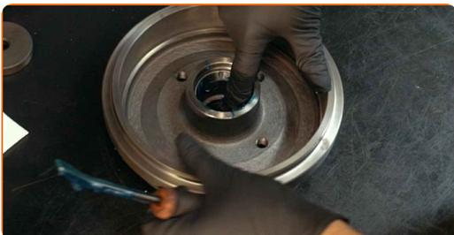
23 Asenna uusi pyöränlaakeri paikoilleen ja kiinnitä se.
