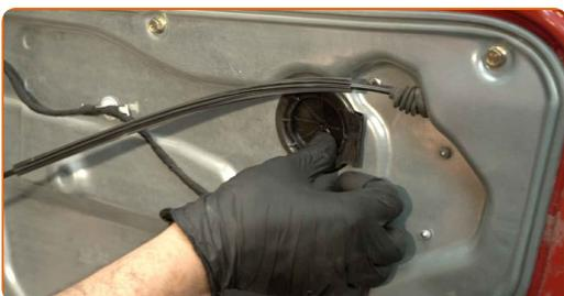
**51** Kiinnitä peilin säätimen liitin ohjausyksikköön.
