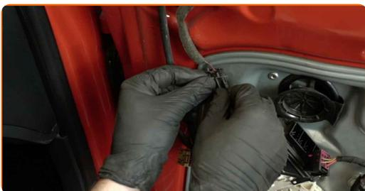
45 Kiinnitä johtosarja oven suojakanteen.
