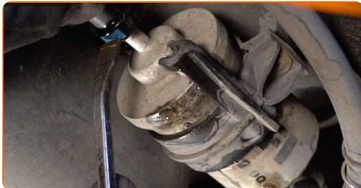
Vaihto: polttoainesuodatin – VW Polo III Hatchback (6N1). Ammattilaiset suosittlevat:
