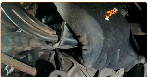
14 Kierrä irti moottorin käynnistimen kiinnikkeet. Käytä hylsyä nro 13. Käytä kiintolenkkiavainta.
