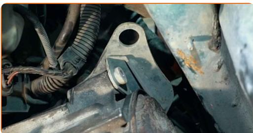
**70** Kierrä kiinni kiinnikkeet, jotka yhdistävät vaihteiston tuen vaihdelaatikkoon. Käytä yhdistelmäavainta nro 16.
