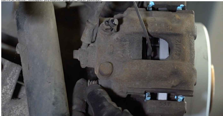
24 Asenna jarrukenkien pidikejousi paikoilleen.
