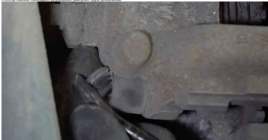
12 Irrota jarrusatulan kiinnikkeet. Käytä kuusiokoloavainta nro H7. Käytä kiintolenkkiavainta.
