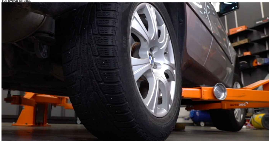
6 Löysää pyörän asennuspultteja. Käytä vannehitsysä nro 19.
