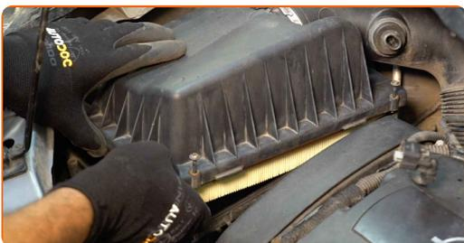
**6** Irrota suodatin suodattimen kotelosta.
